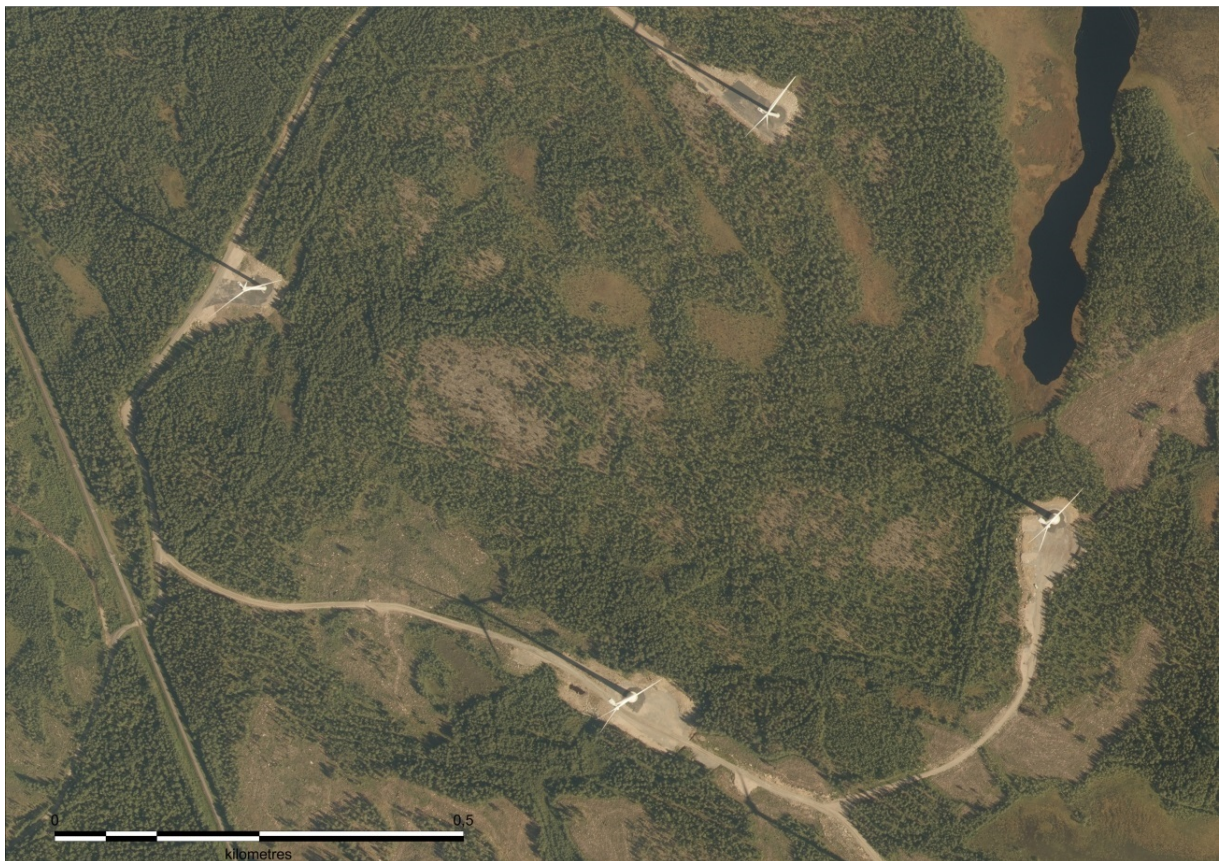
Kuva 15. Ilmakuvassa näkyy toiminnassa olevia tuulivoimaloita, huoltotiet ja nostokentät. Tuulivoimaloiden ympäristössä ja välialueilla aikaisempi maankäyttö on säilynyt ennallaan.
